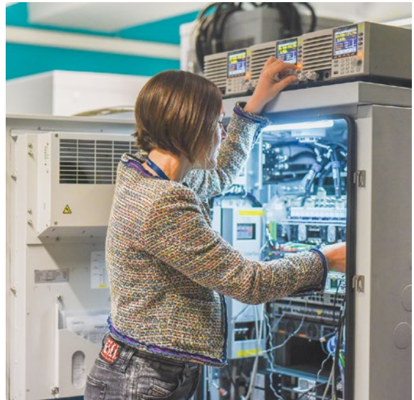
Za potrebe testiranja u ovom području u kompaniji je smješten i tzv. „Battery lab“. Ime je dobio po specifičnoj namjeni i sigurnosnim uvjetima koji su potrebni za pohranu i testiranje smart baterija u litij-ionskoj tehnologiji.
